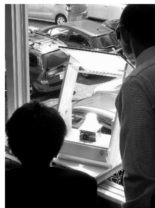
図. 製作したミニ太陽炉による \text{Fe}_2\text{O}_3 の還元
